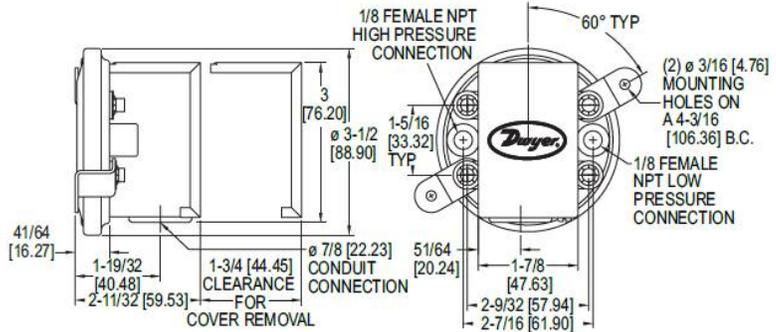
系列1910压力开关。所有压力和电气连接和设定点调整都在一侧，便于安装。
